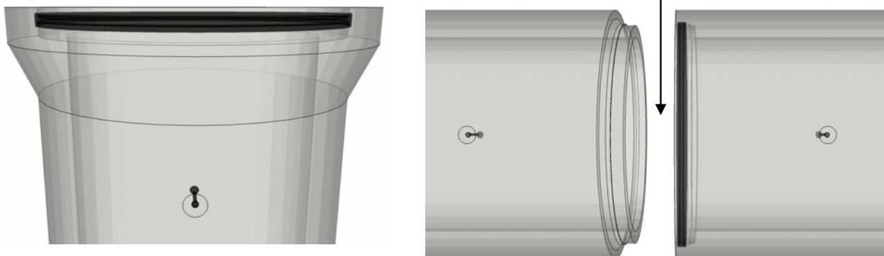
Particolare posizionamento guarnizione incorporata nel giunto
